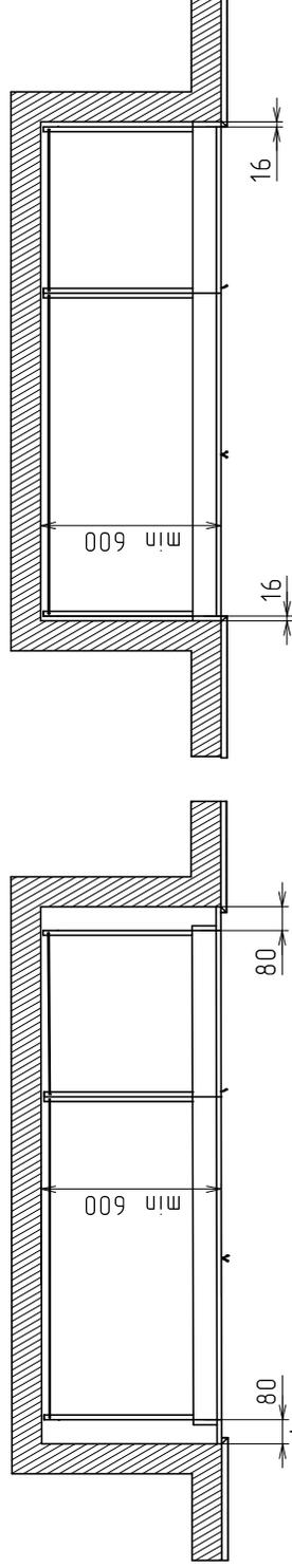
Вариант шкафа в нише, добор может быть 16 мм или 80 мм
