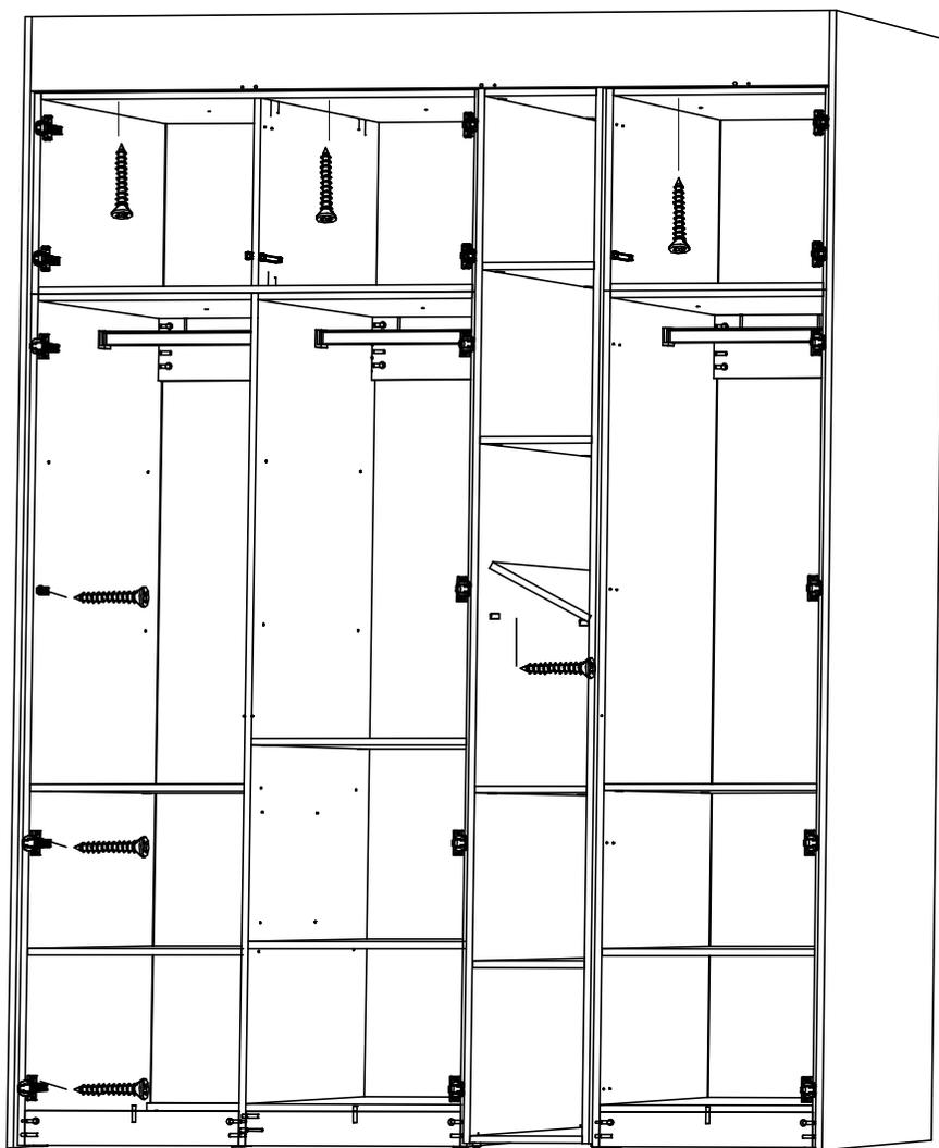
Корпуса и доборы крепим между собой при помощи саморезов 3,5x30 в невидимых местах, под полкой съемной или под ответной планкой петли
